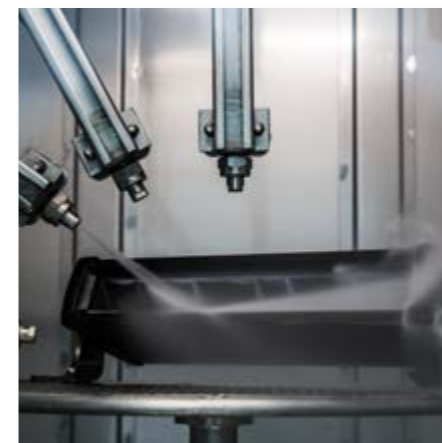
Wasserresistenz IP Schutzklasse IP67/69K
