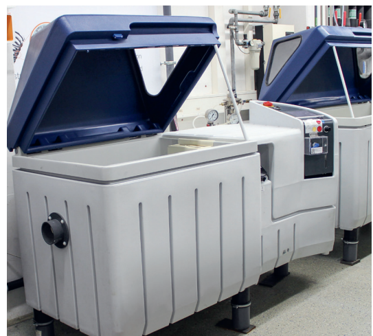
Die Salzsprühprüfkammern ermöglichen reproduzierbare, zeitgeraffte Korrosionsprüfungen.
