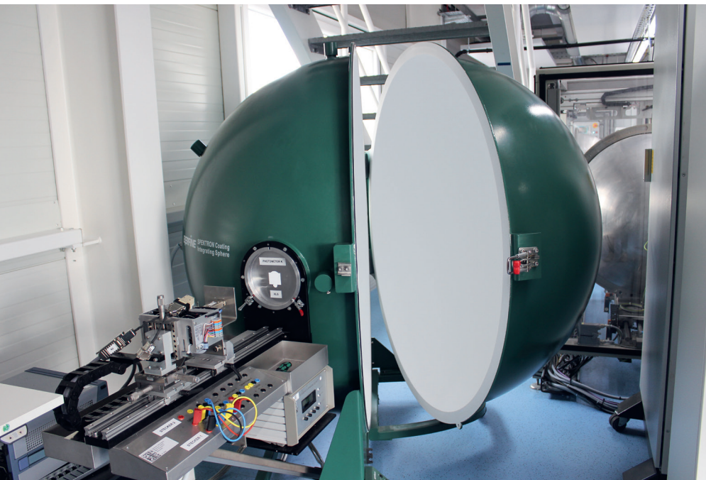
Ulbricht Kugeln bieten die Möglichkeit, Lichtquellen verschiedenster Art auf Lichtstrom und spektralen Strahlungsfluss zu vermessen.
