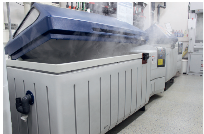
Industrielle Werkstoffe werden durch eine Salzsprühnebelprüfung auf Korrosionsbeständigkeit geprüft.
