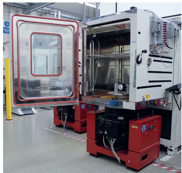
Elektrodynamische Shaker werden für die Anregung von Schwingungen verwendet.
