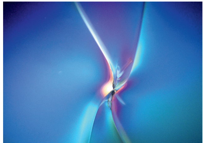
Spannungsriss – 200-fach vergrößert Digitalmikroskop VHX-
