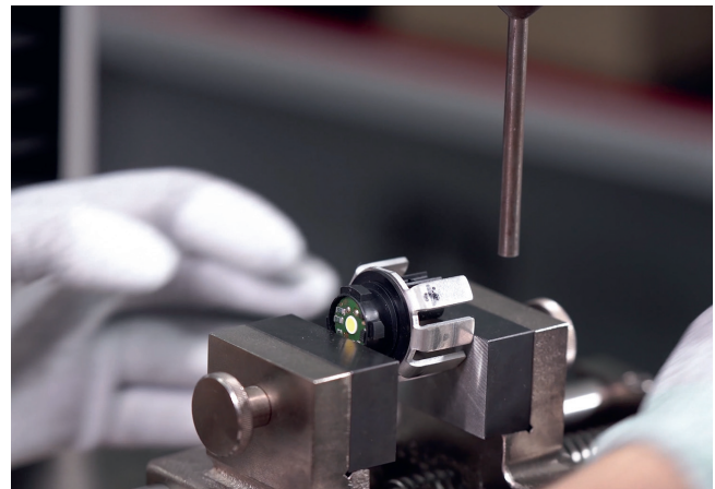
Mit unseren Zug-/Druckprüfungen bieten wir Festigkeits- und Bauteiluntersuchungen bis 5 kN.
