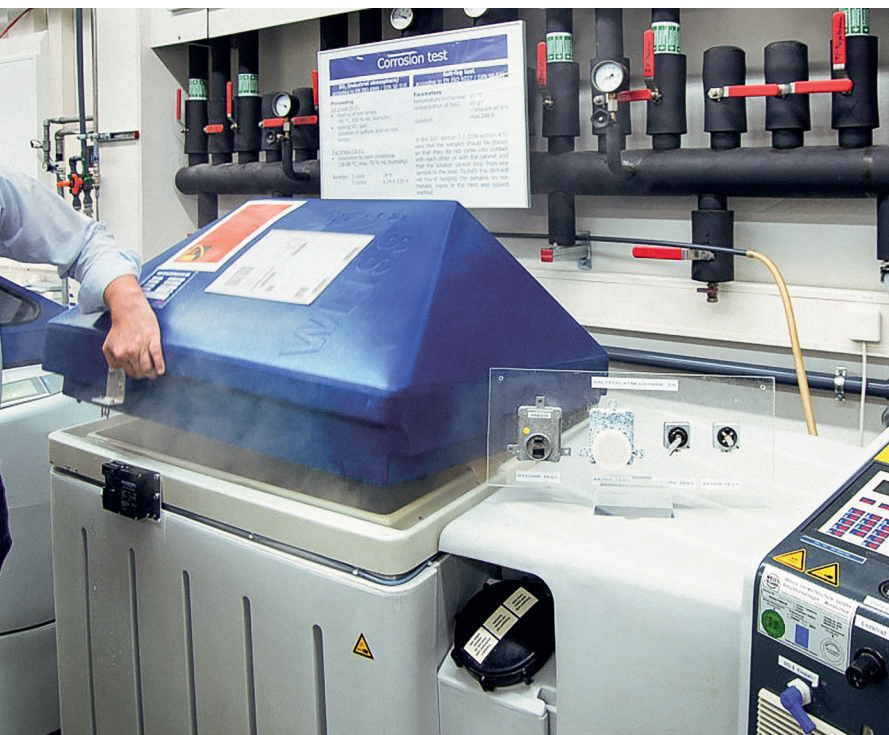
Die Salzsprühprüfkammern ermöglichen reproduzierbare, zeitgeraffte Korrosionsprüfungen.
