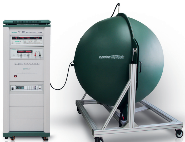
Ulbricht Kugeln bieten die Möglichkeit, Lichtquellen verschiedenster Art auf Lichtstrom und spektralen Strahlungsfluss zu vermessen.
