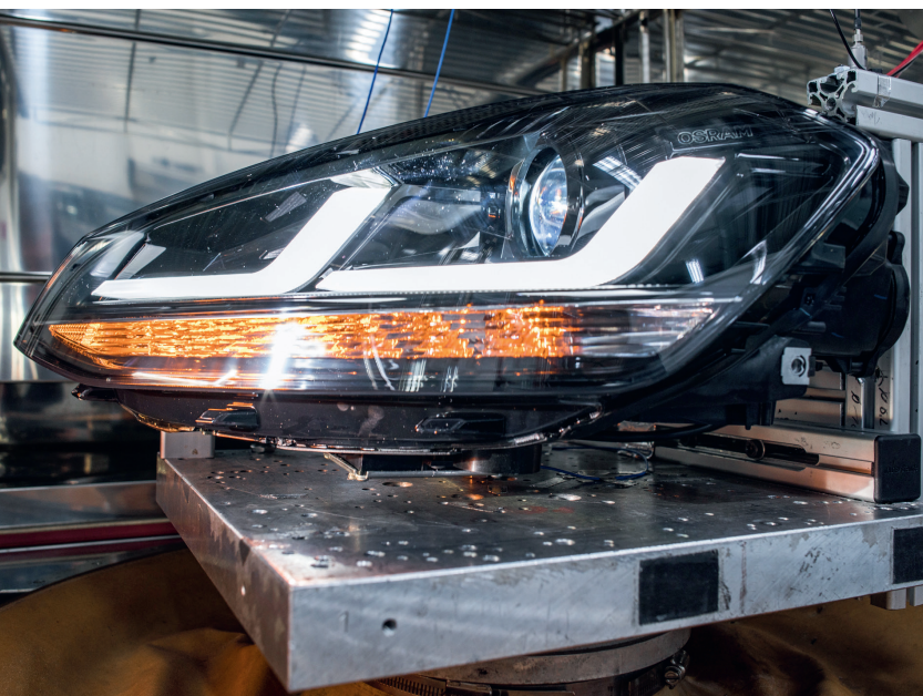
Elektrodynamische Shaker werden für die Anregung von Schwingungen verwendet.
