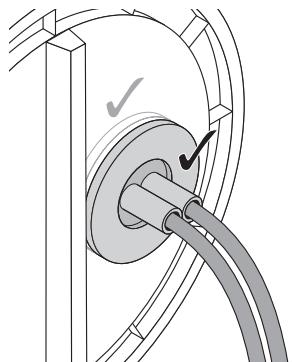
Seal using rubber gasket.<sup>4)</sup>
