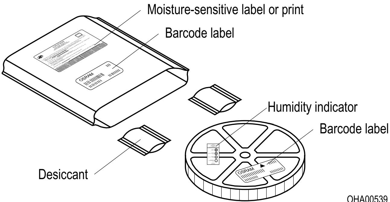
根据JEDEC-STD-33,湿敏产品包装在一个干燥的袋子中，包含干燥剂和湿度卡.
